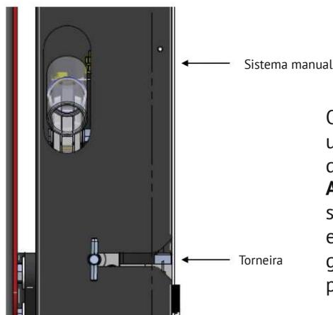
O sistema manual e a torneira permitem a utilização da plataforma, em caso de falha de energia.
