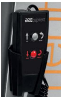
O comando que se encontra ligado ao quadro elétrico permite ao operador controlar o equipamento a partir de uma distância de segurança. Este funciona quando o interruptor principal está na posição "ON".
