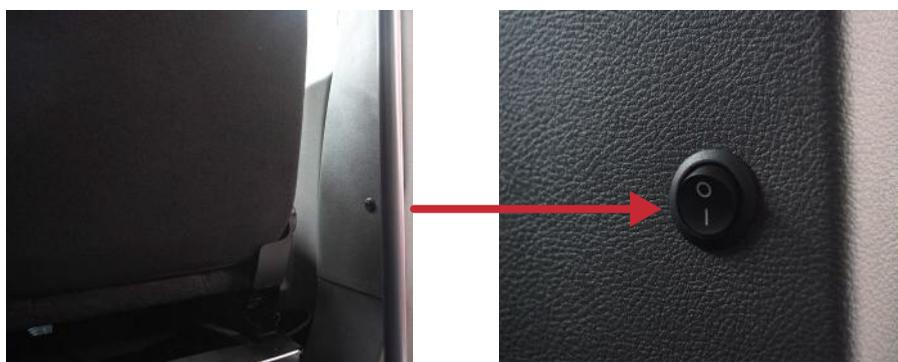
Interruptor localizado na coluna da divisória, junto da porta lateral conforme indicado na fotografia.
