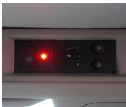
**Nota:** Em todas as transformações é colocado um led luminoso conforme a fotografia, em que é possível verificar o estado do degrau.
