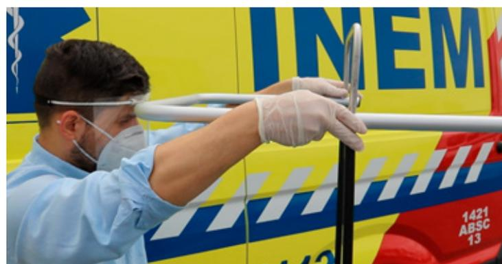
3. Proceder ao alinhamento da tubagem superior com os suportes e montar os 2 suportes superiores.
