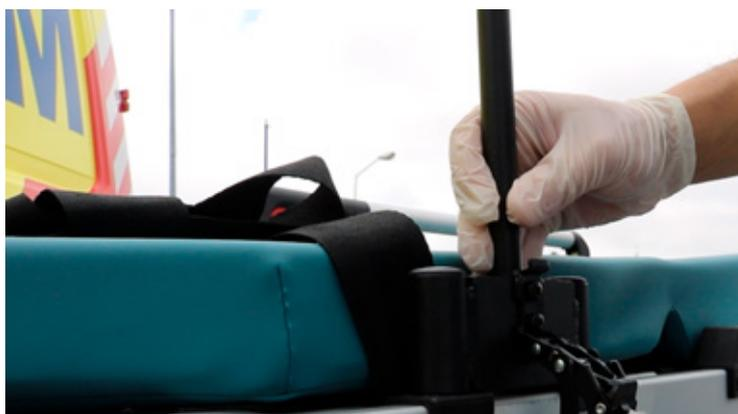
1. Primeiramente é necessário que sejam fixados os 4 suportes incluídos no kit CAM (fixar com a abraçadeira de ajuste), estas assentam nos perfis de alumínio da estrutura principal da maca;
